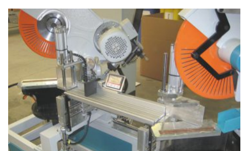
...beide Sägeaggregate für den linken und rechten Schnitt parallel und exakt auf das vorgegebene Längen-Fixmaß stellen sich per Knopfdruck am Bedientableau selbsttätig ein
