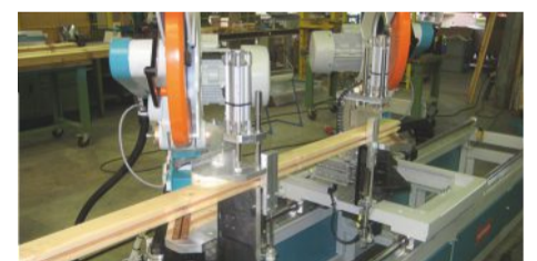
Zuschneiden und Kappen von Sichtholzblenden aus Massivhölzern...
